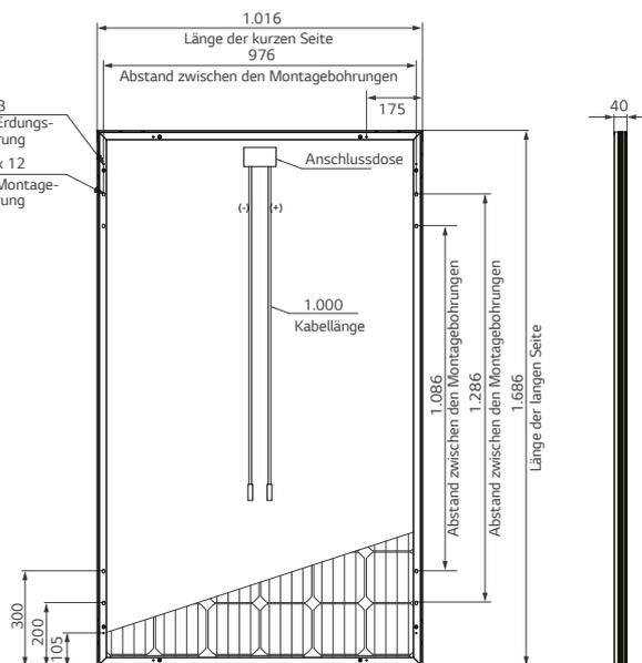
Der Abstand gilt zwischen den Mittelpunkten der Montage- und Erdungsbohrungen.
